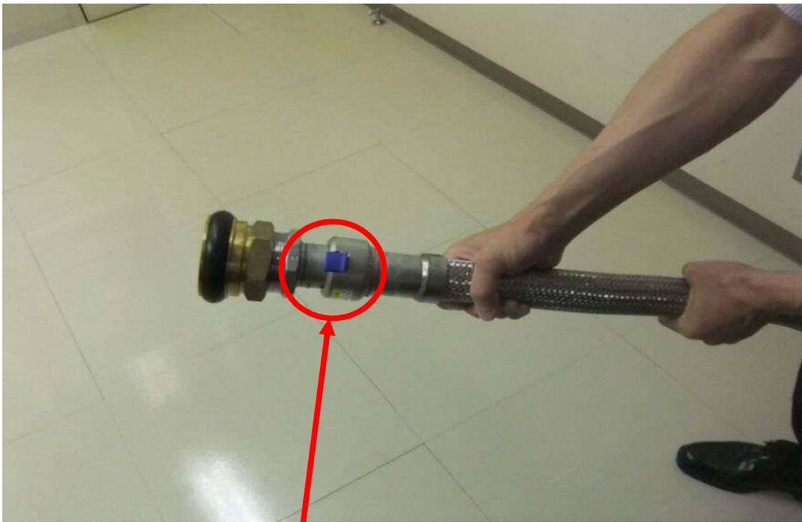
⑦ 給水車との連結をする場合、もう1本のフレキ管の一方にカップラーを差し込み、キャップをします。
