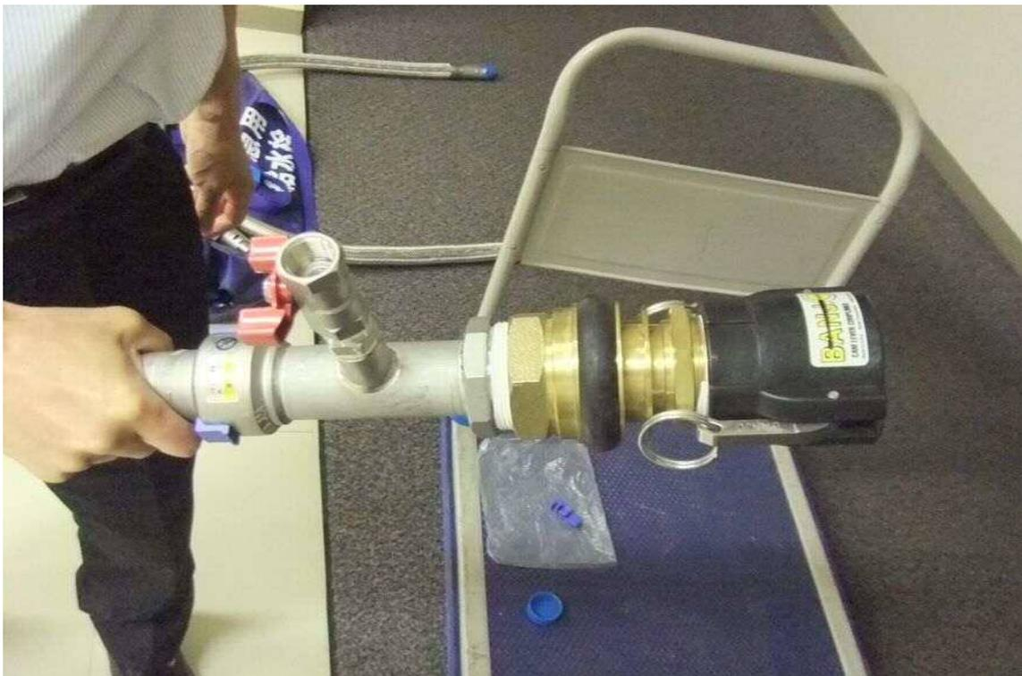
⑥ カムロックを差し込みます。カムロック部をダンボール貯水槽給水口に差し込みます。
