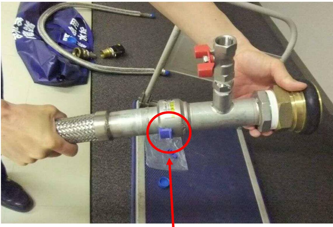
⑤ 空気抜きバルブを差し込み、キャップをはめます。
