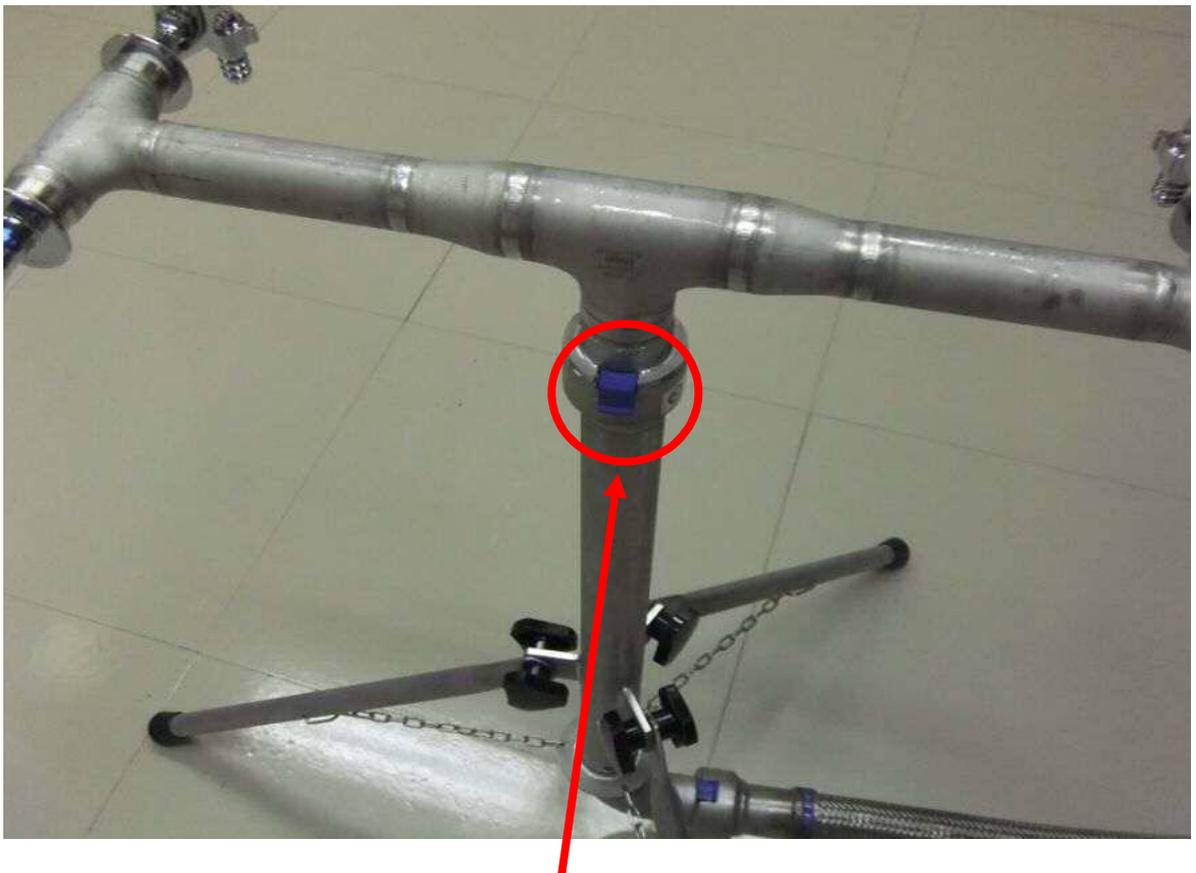
④ 水栓取付管を差し込み、キャップをはめます。
