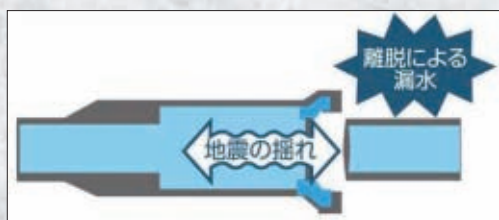
耐震化されていない水道管
