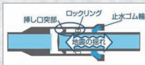
耐震化された水道管
