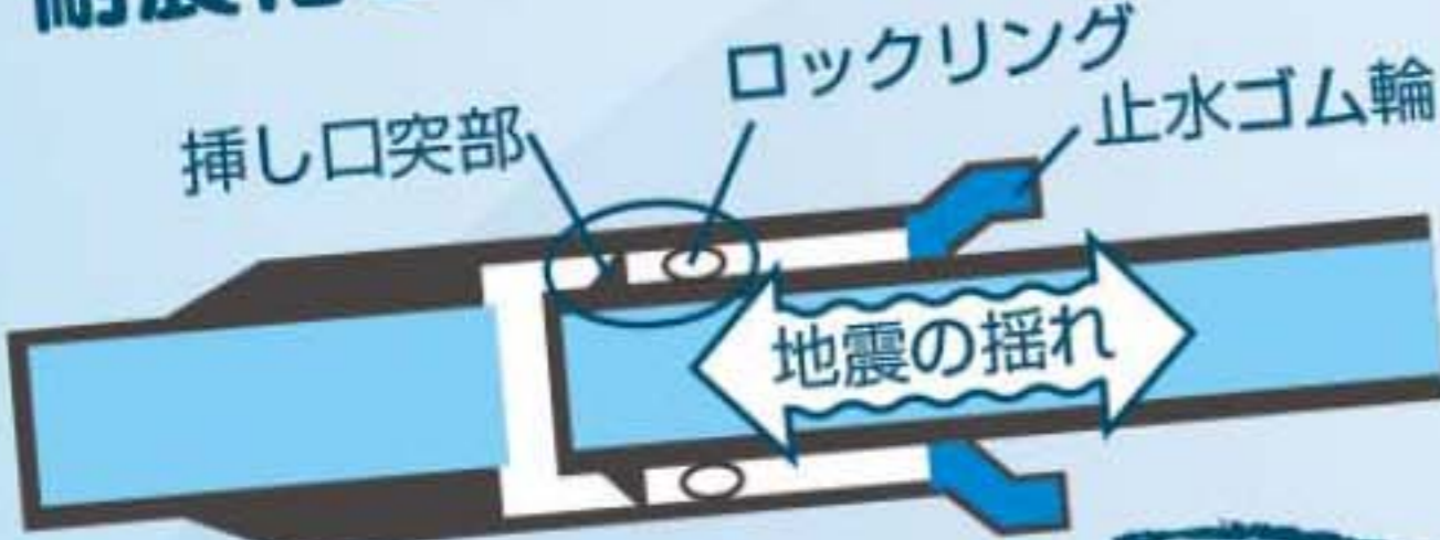
▲耐震管への布設替え
